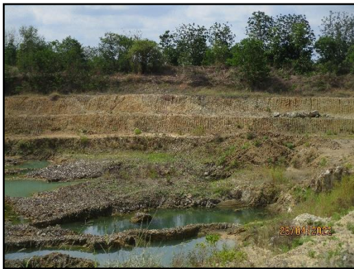
ภาพที่ 2.22 การเปิดหน้าเหมืองลักษณะขั้นบันได
